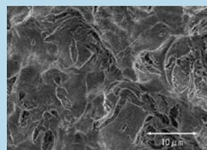
結晶化度95%以上のHAを薄膜コーティングすることにより、埋入初期では骨伝導能により早期にバイオインテグレーションを獲得し、最終的にはチタンと骨の直接結合を目指します。
