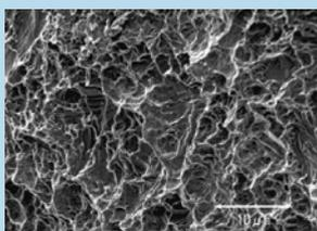
ナノメートルレベルでコントロールされた表面微小構造とGDT(グロー放電処理)効果により、表面の濡れ性を高め、早期の骨形成、強固な骨結合を実現します。
